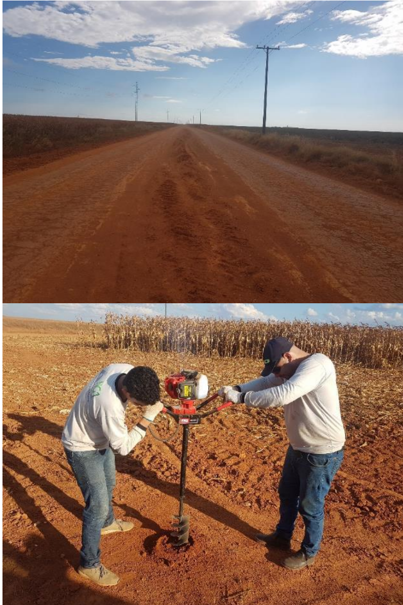
Figura 14- Corpo estradal recortado solo argilo areno siltoso Formação Utiariti, próximo ao início do trecho.
