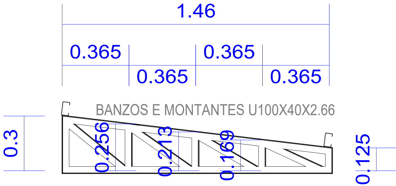
02 TESOURA - COBERTURA ESCALA: 1/50
