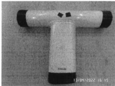
Antes do início dos ensaios amostras sem pontos de corrosão.
